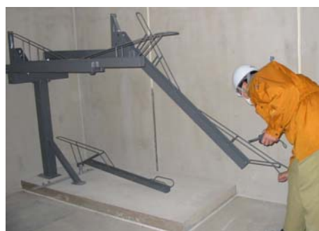
駐輪ラックの浮き床防振対策実験
